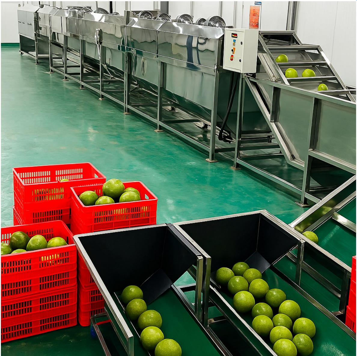
Hình 3. Hệ thống thiết bị đồng bộ sơ chế phù màng cho trái bưởi xuất khẩu (Sản phẩm được thiết kế chế tạo bởi Viện Cơ điện nông nghiệp và Công nghệ sau thu hoạch)
